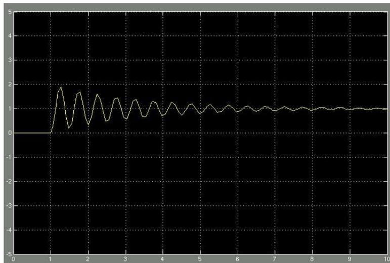
Nous observons que les oscillations ont donc été amorties par notre contrôle actif des vibrations.
